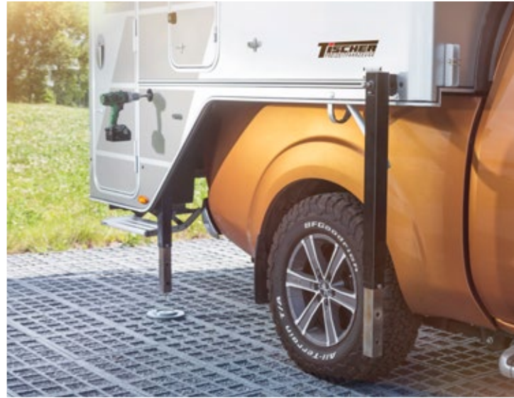
Stützen ausfahren mit Akkuschauber oder Kurbel
